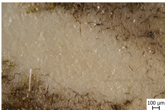
Obr. 29: Povrch laminátu po čištění ArF excimerovým laserem s fokusovaným zářením ( E=41,7 mJ, počet pulzů 30)
