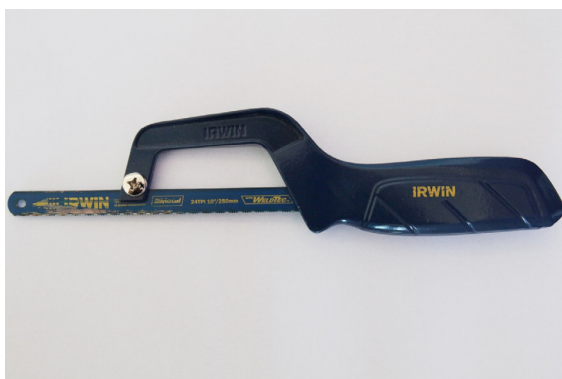
Obr. 4: Pilka na železo vhodná k odběru vzorku laminátu pro zkoumání stratigrafie
