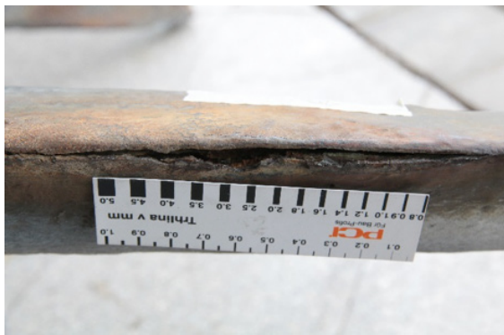
Obr. 8: Prasklina v celé tloušťce laminátu
