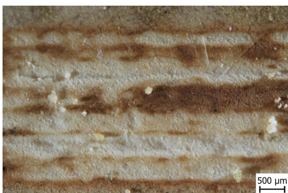
Obr. 30: Povrch vzorku po čištění TEA CO_2 laserem ( E=500 mJ, fokusovaný svazek, počet pulzů 1)
