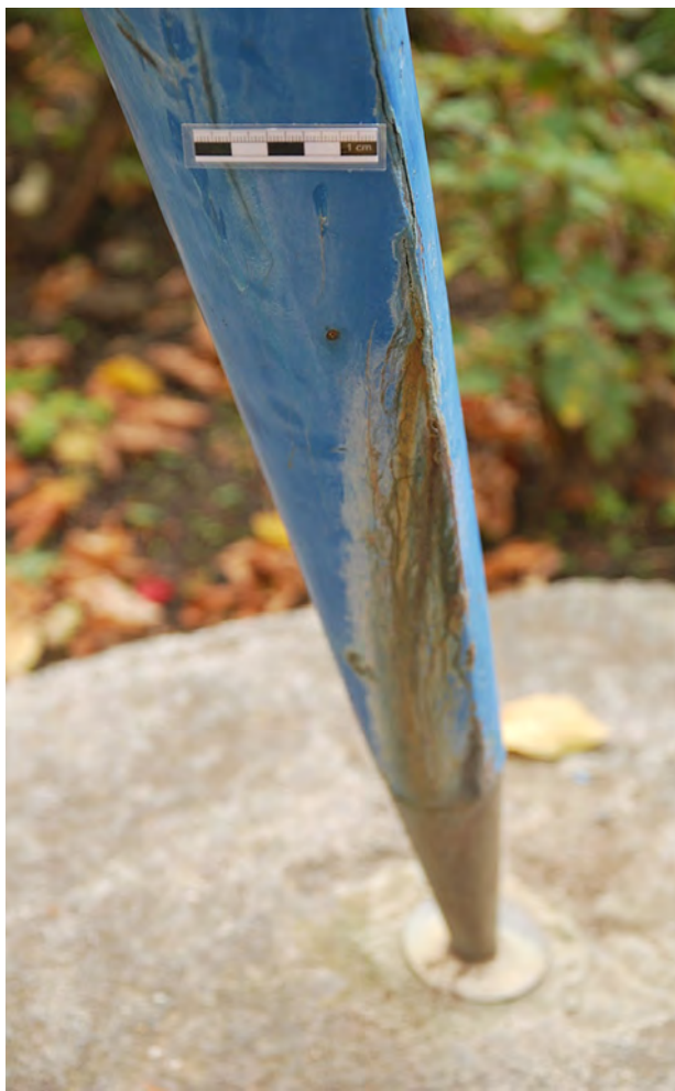
Obr. 12. Znečištění povrchu sochy korozními produkty železa
